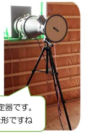
それでは測定開始→しばらくするとピーピー測定完了。数値は? と思いきや、、エラーですね。と検査員の一言!!^; 2回目もエラーが続き、もしかしてどこかに大きな隙間が空いて気密が取れていないのかとみんなが焦ってきたところに... 検査員の方が「データ上では通気量(空気の流れ)が少なすぎて計測できないためエラーになっている。気密が凄すぎて計測できない」と言われました。0.1以下では測定不能になるのだそうです。しかたなく、検査のために仮に閉じた吸気口に小さな穴をあけて計測しました。実際には穴をあけていなければ0.05~0.06ぐらいの凄いな数値で、この仕事をされてから 過去最高の数値だそうです!
